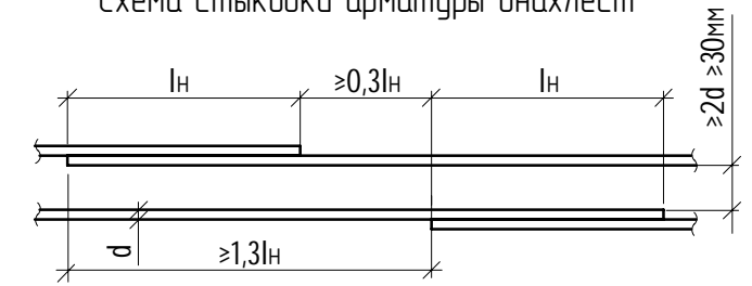
Схема стыковки арматуры внахлест
